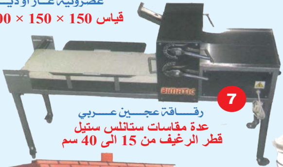
SMART MACHINE قطاعة ورقاقة آليّة للعجين تقطع من 40 إلى 180 غرام ترقق من 15 إلى 40 سم
